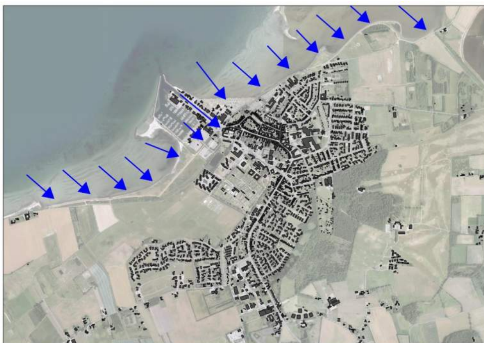
Figur 2-2 Bogense er udsat i forhold til havvandsstigninger. På den korte bane primært de arealer som ligger uden for de eksisterende diger.
