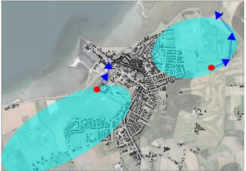
Figur 2-8 Skitsering af de nedpumpede områder med angivelse (rød prik) af pumpestation samt blå pile til markering af udløb.
