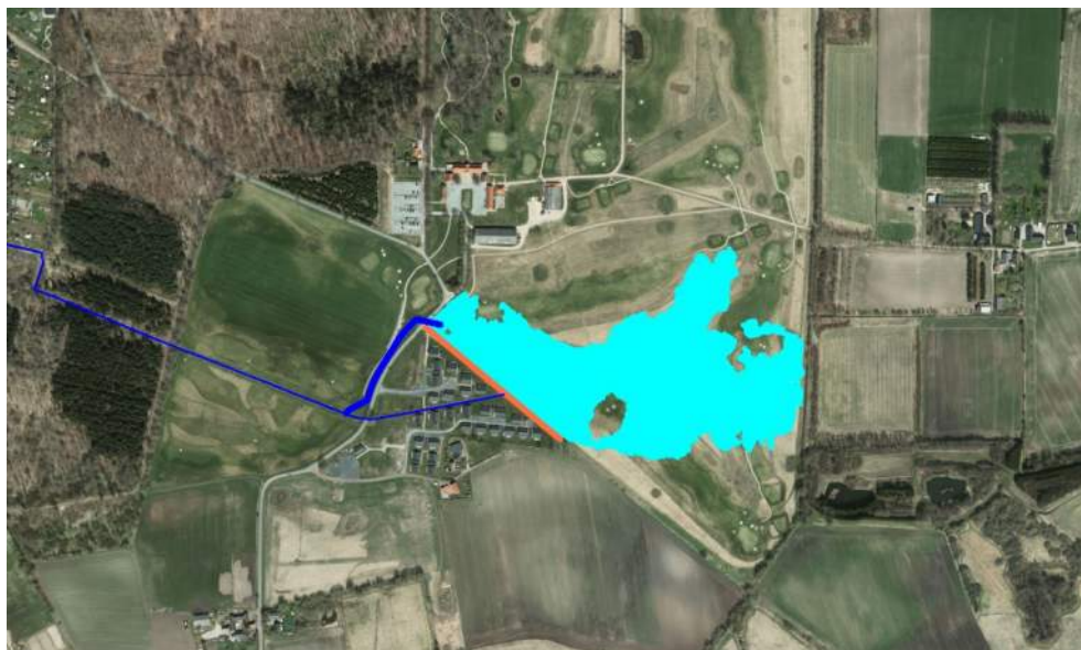
Figur 3-6 Mulig tilbageholdelse af Kristianslund Østre Enge. Den brune linje er et dige. Vandløbet er nu rørlagt under det område, der er vist som en sø, men bassinet vil kun sjældent være i brug. Den nordlige blå streg er et foreslået overløb.
