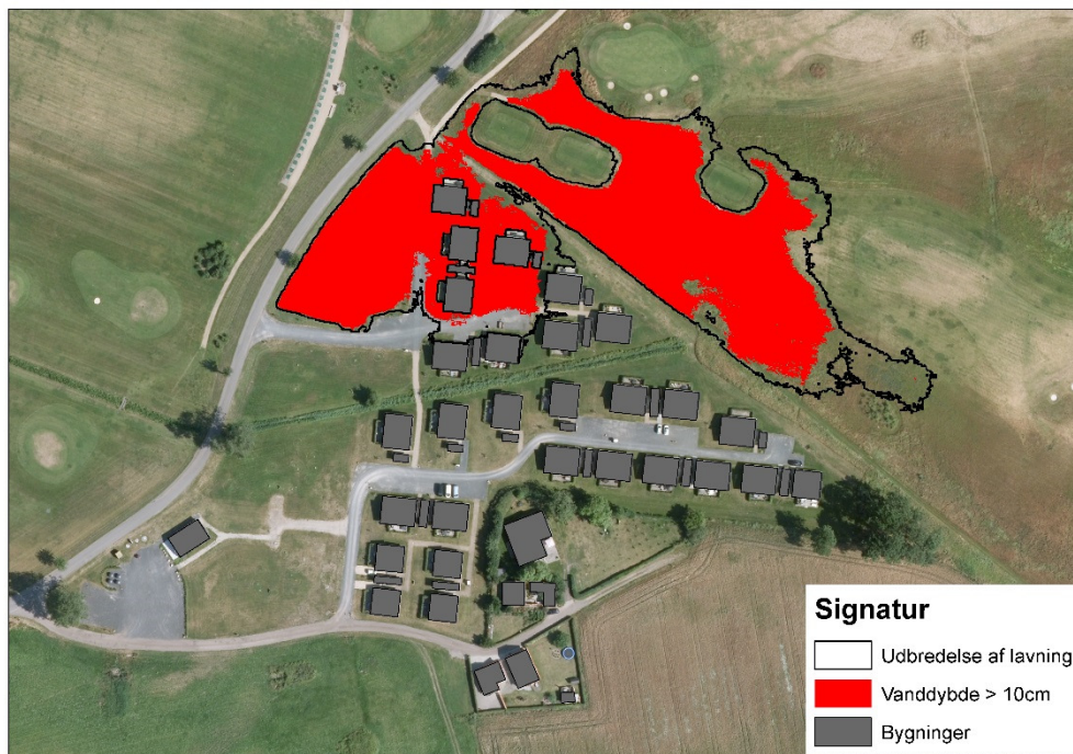
Figur 6 Visning af lavning som giver problemer med oversvømmelse af feriehusene. Rød farve angiver en minimumsdybde på 10 cm, som oftest er kriterie for bygningsskader.
