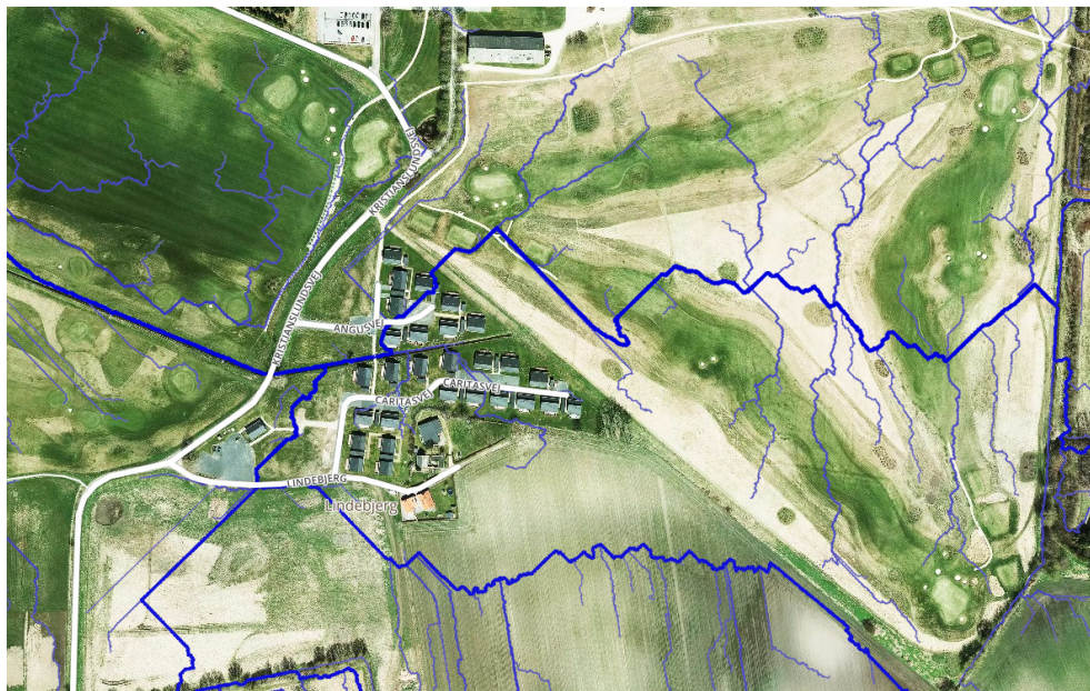
Figur 1 Strømningsveje på terræn, som vandet vil følge, når kapaciteten af det rørlagte vandløb overskrides.
