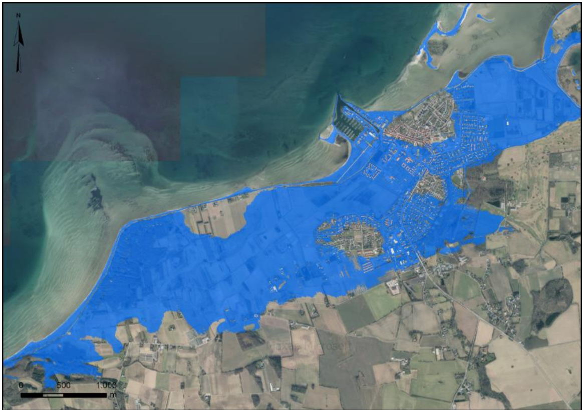
Figur 2-1. Udbredelse af oversvømmelse som følge af en 500-års hændelse i år 2070 (+2,18 m DVR90) under eksisterende forhold. Data hentet fra Scalgo.
