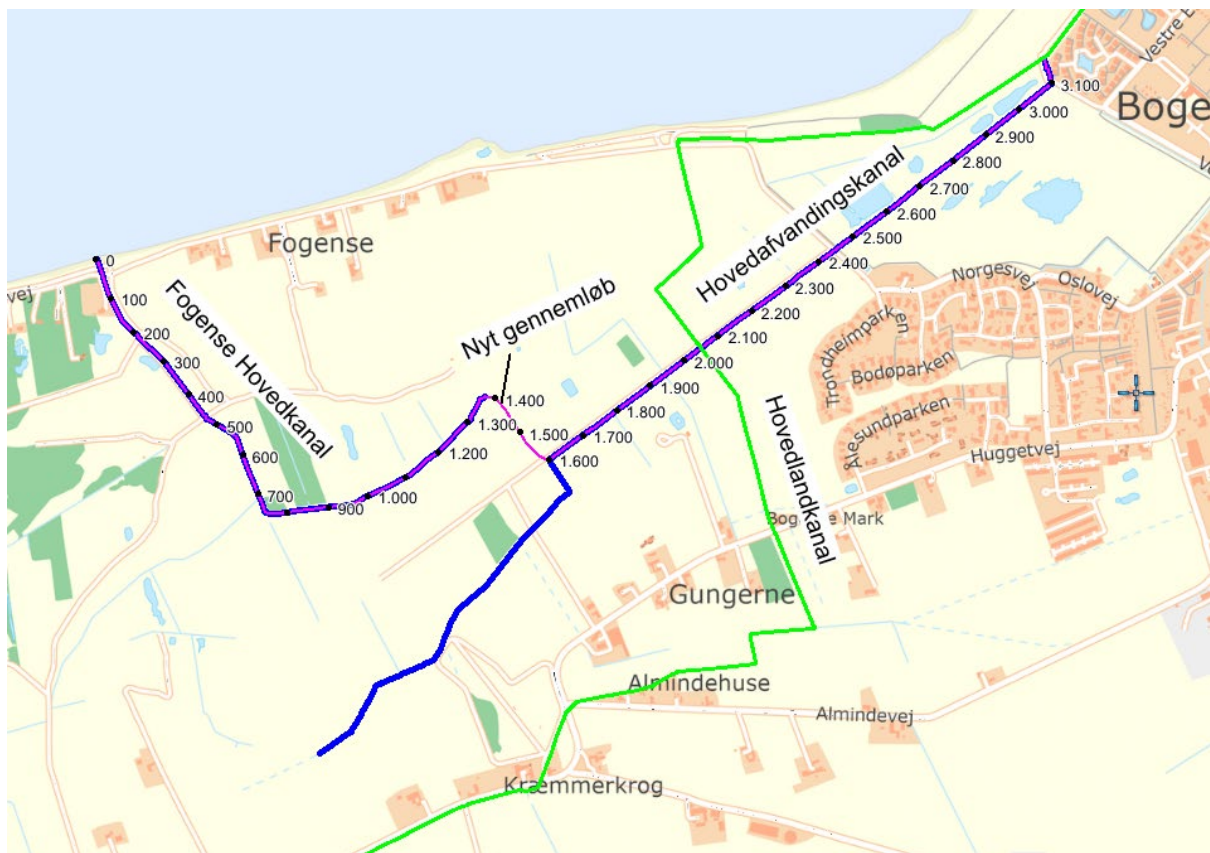
Figur 2.1 Oversigt. Blå streger: Eksisterende Hovedkanal i Fogense Enge og Hovedafvandingskanalen i Bogense Vesterenge. Grøn streg: Hovedlandkanal i Bogense Vesterenge. Pink streg: Ny linie med gennemløb fra Fogense Enge til Bogense Vesterenge, inkl. stationering.
