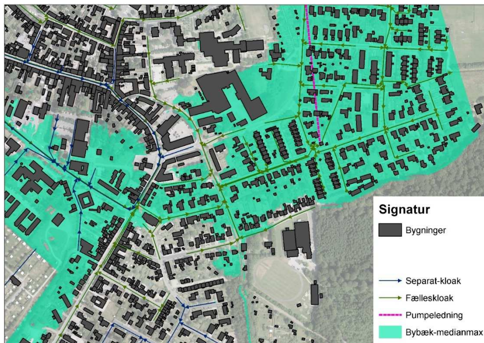
Figur 3-3 Områder der ligger lavere end vandspejlet i Bybækken ved medianmaksimum. Der kan ske oversvømmelser opstrøms Skovbrovej/Skovvej og i området Skovvej, Plantagevænget, Mejerivej og Bøgevej. Vandet vil strømme mod øst og vest, dvs. til både Østre og Vestre Enge.
